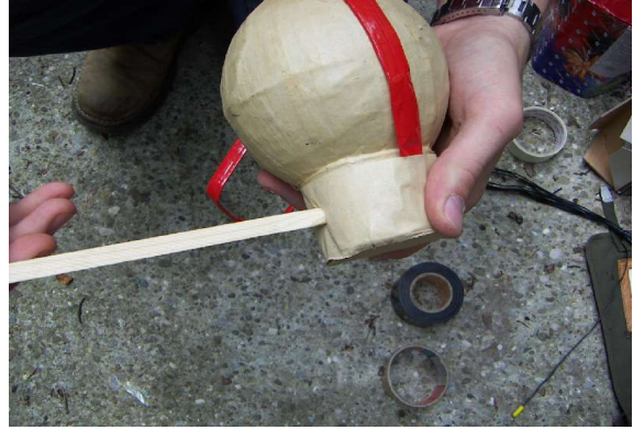
Abb. 14: Stechen des Anzünderloches
