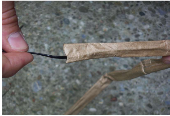
Abb. 18: Einsetzen des Anzünders
