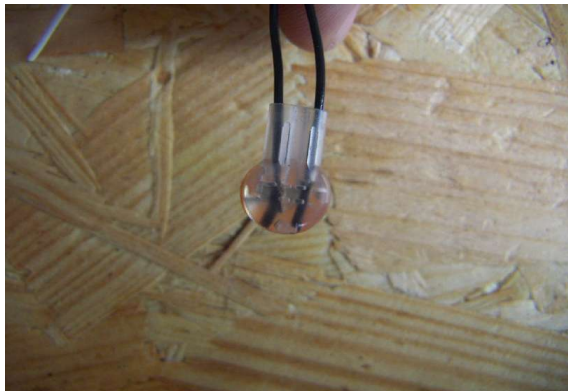
Abb. 59: Drähte müssen bis zum Anschlag eingeführt werden
