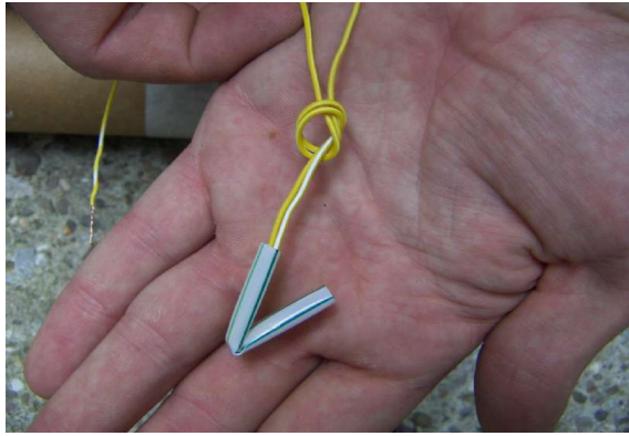
Abb. 56: Sicherung mittels Sackstich
