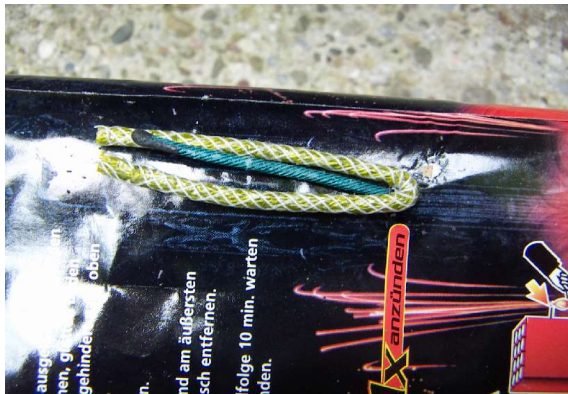
Abb. 23: Zündern einer Batterie KI II Anbringen der Anzündlitze
